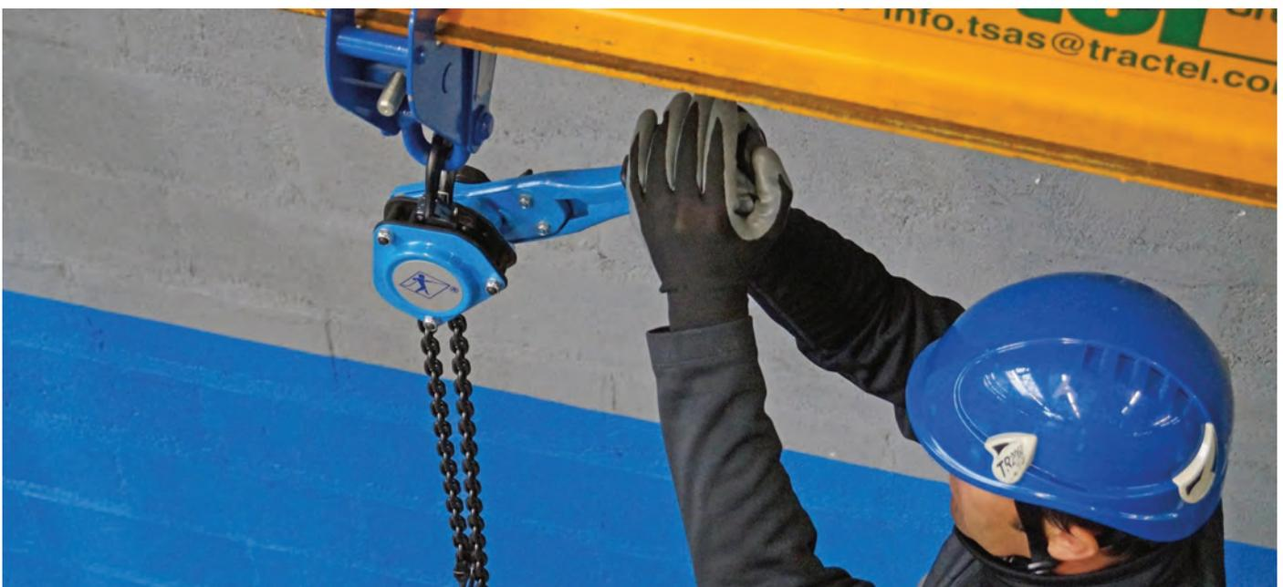
Cette gamme permet l'accrochage d'appareils de levage et le déplacement longitudinal de charges. Ce déplacement est réalisé soit par poussée sur la charge, soit par chaîne de manœuvre.
