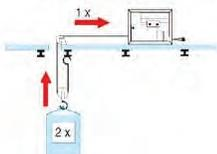
Si la capacité en traction directe n'est pas suffisante, augmenter la capacité par mouflage du câble par une ou plusieurs poulies.
