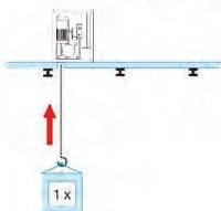
En passant le câble par l'ouverture d'un plafond ou d'un mur pouvant résister à la charge, placer le treuil en appui.
