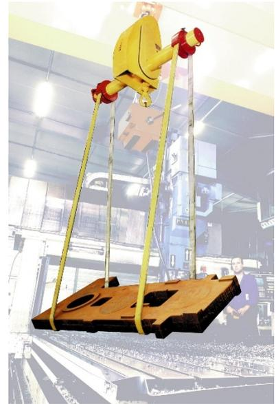
PalTurn™ est constitué d'un tube - mis en rotation™ par un moto-réducteur – sur lequel sont fixées des poulies qui entraînent des sangles. Une boîte à boutons permet le pilotage du système.
